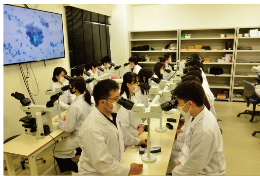
写真5 22人が同時に鏡検できる ディスカッション用顕微鏡(22人鏡)
