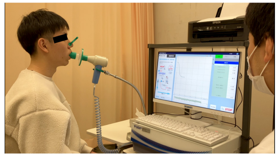
図 1 ハイブリッド・シミュレータによる機能的残気量の測定風景
